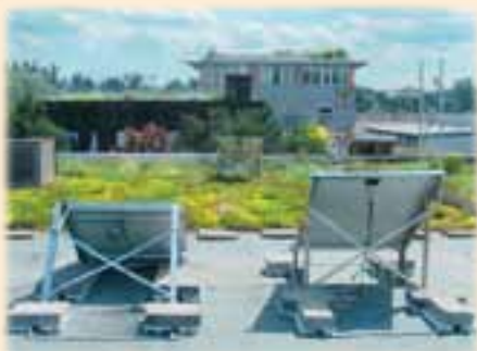
Beim Versuchsaufbau auf einem ZinCo-Dach wurden die Temperatur-Differenzen verschiedener Dachaufbauten über das gesamte Jahr 2009 hinweg gemessen.
